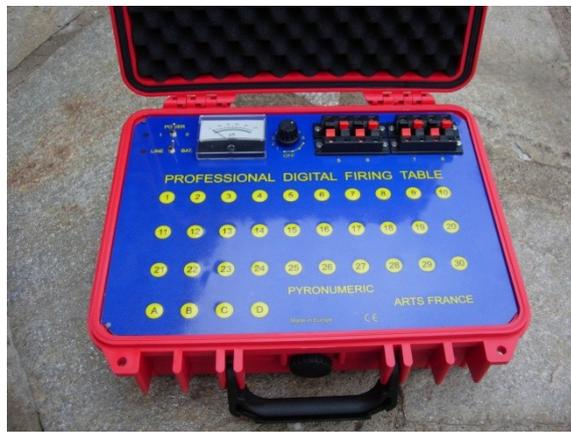
Elle permet la commande de 8 « Systèmes » dont chacun est relié par une paire de fils à des récepteurs décodeurs et à des boîtiers de 30 relais (voir les modules en fin de documentation).
