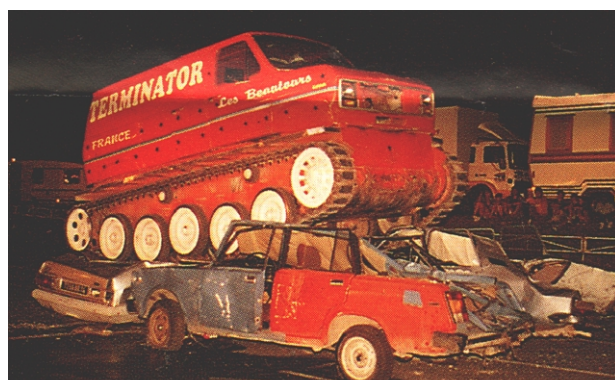
LES "TERMINATORS": Camions construits sur châssis et moteur de char A.M.X. 13.
